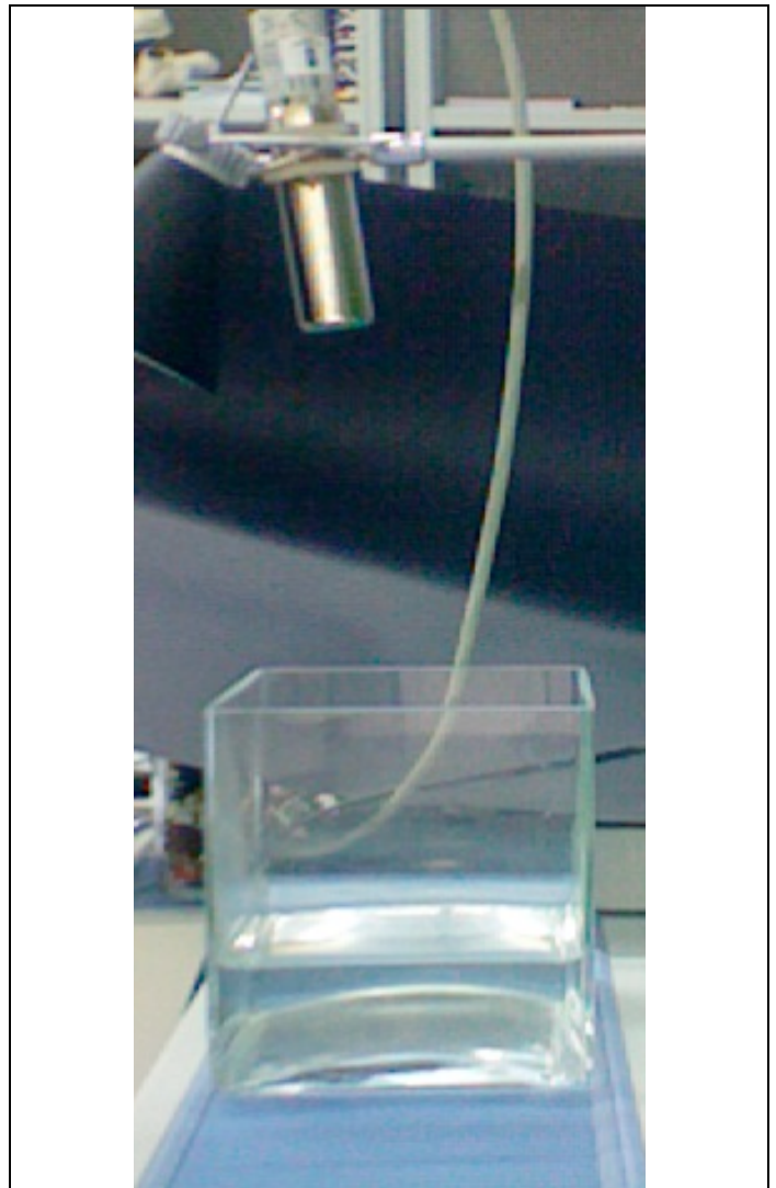
Fig. 10.- Fotografía del recipiente con el fluido y el sensor de ultrasonidos.
